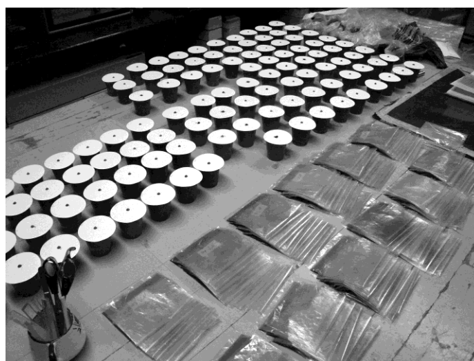
Figura 8 1 mg. de muestra de cerámica colocada al centro del papel Whatman sin cenizas #42.
