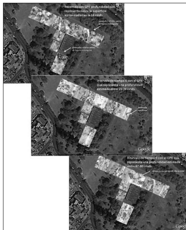
Figura 2. Gráfica que muestra la localización de anomalías rectilíneas en cortes de tiempo de tiempo 1, 4 y 9.
